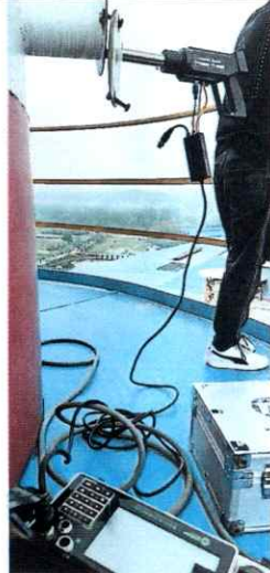
① 窑废气排放口 DA002 附图 1 现场监测照片
